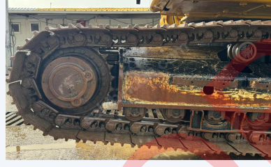
Palet zinciri ve pabuç aşınma durumu Başlangıç seviyesinde aşınmalar mevcut.
